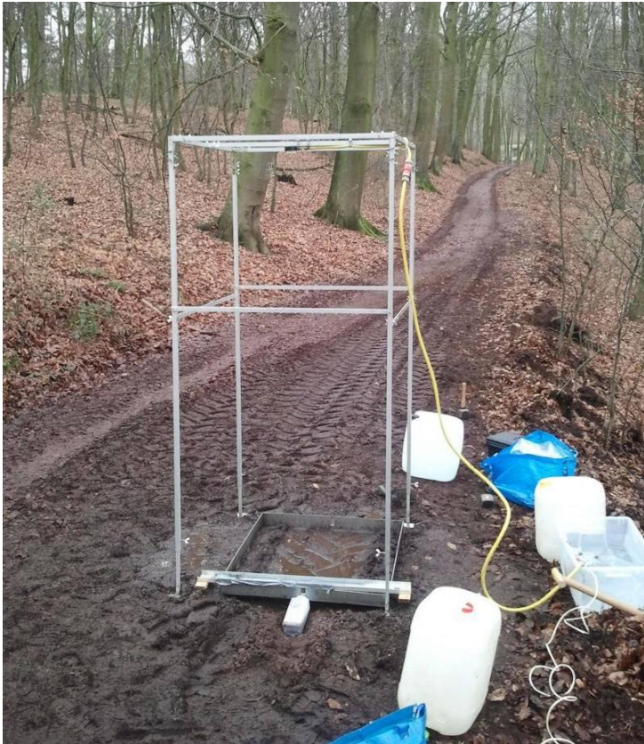
Foto einer Beregnungsanlage [2].
