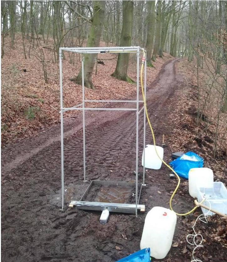
Foto einer Beregnungsanlage [2].
